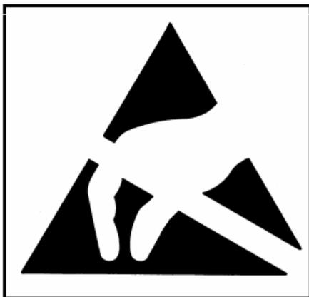
带有这个警告标志的电气连接不可触摸和在未有执行静电放电 ESD 防范措施前连接插头和插座。
